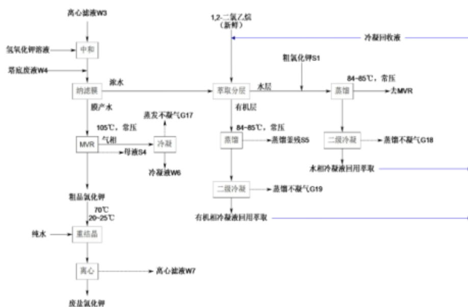
图 4.1-2 废盐处理工艺流程图
